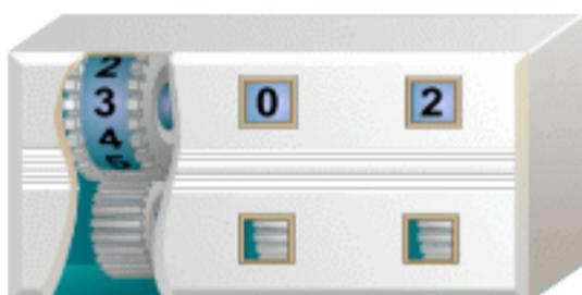
На рисунке показана одна ячейка устройства. Она вмещает 3 цифры. Кузя устанавливает цифры, вращая колесики.
